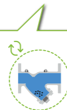
Exdirt V, Stahl, für vertikale Montage DN 50 - DN 100 ersetzt eingebaute Schmutzfänger
